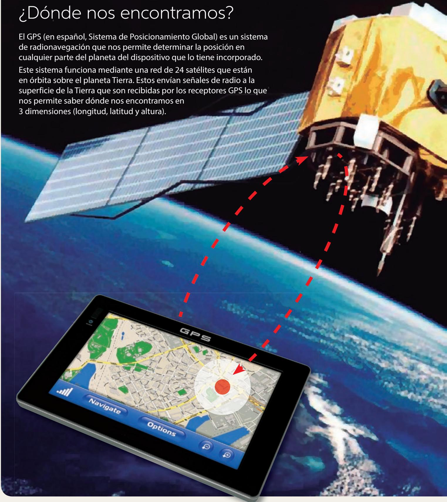
El funcionamiento del GPS consiste en determinar la distancia entre el receptor y al menos tres satélites, como se detalla a continuación:
