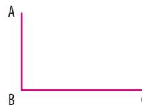
Con una escuadra apoyada en AB, medir el lado BC. Deslizarla hasta A y dibujar el lado AD. Finalmente, unir D con A y D con C.
