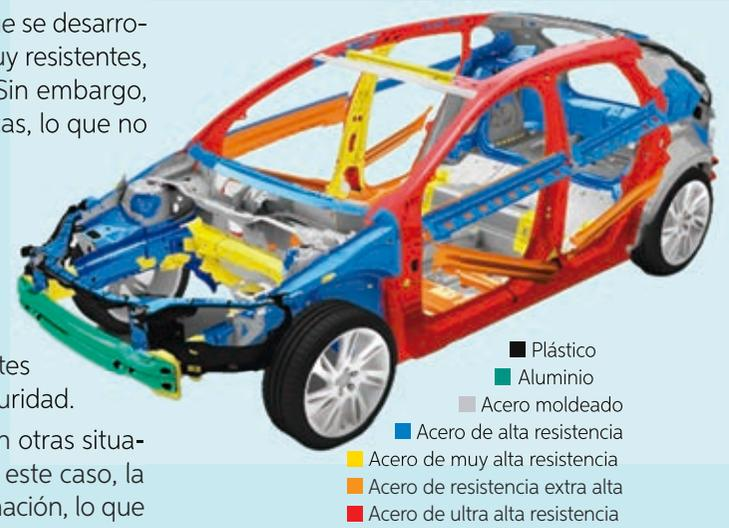
↗ Estructura de un vehículo y sus zonas de deformación programada.
