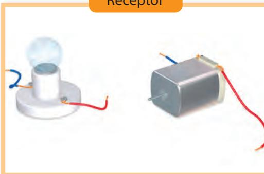
Son componentes fundamentales de un circuito, y a través de ellos se puede transformar la energía eléctrica en lumínica, térmica, sonora o cinética. Son ejemplos de receptores una ampolleta, un motor eléctrico o un timbre.
