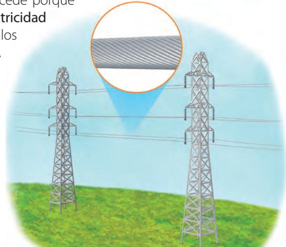
Los cables de los tendidos eléctricos pueden ser de cobre, acero o aluminio, ya que estos tres metales son buenos conductores de la electricidad.
