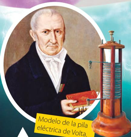
Modelo de la pila eléctrica de Volta.
