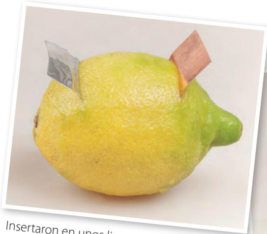
Insertaron en unos limones dos láminas, una de latón y otra de cobre, tal como se muestra en la imagen.
