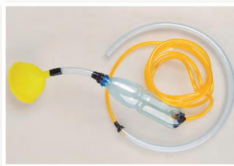
Enrollen las dos mangueras, tal como se muestra en la imagen. Luego, sosteniendo el embudo en alto, viertan en él parte del agua coloreada y observen de qué manera esta fluye y cuánto tiempo tarda en recorrer el modelo.
